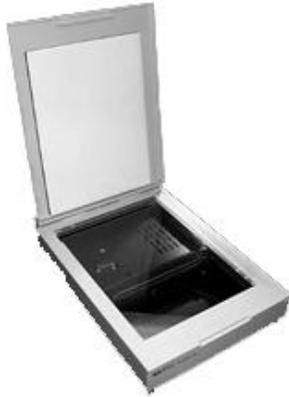
El escáner es un periférico que permite digitalizar imágenes o texto y almacenarlos en el disco duro de la computadora, para su actualización mediante una serie de aplicaciones específicas.
