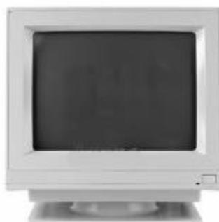
Para poder utilizar el monitor se requiere una tarjeta gráfica conectada a la tarjeta madre de la computadora, ésta envía al monitor los datos que ha procesado a través del RAMDAC (define las frecuencias de refresco), el cual está encargado de transformar la información digital procesada por el equipo a formato analógico para que la entienda el monitor
